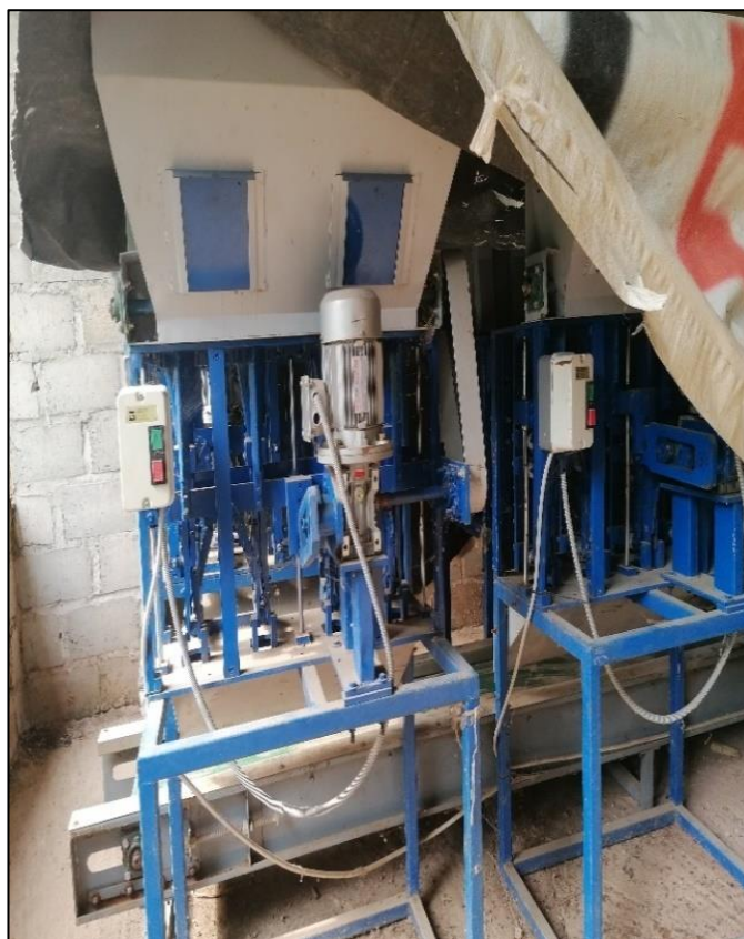
Photo 55: Deux machines électriques de transformation de la noix d'acajou du GIE Balantacounda Multiservices de Simbandi Balante
