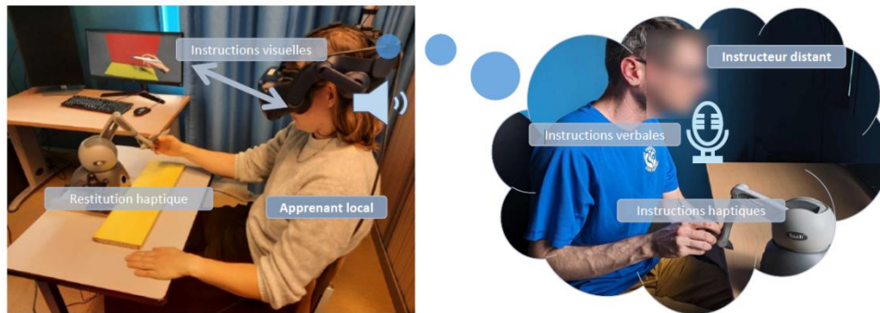
Figure 45 : Illustration de l'étude expérimentale. Croyant qu'il interagit en temps réel avec un instructeur à distance, l'apprenant reçoit des instructions préenregistrées sur l'amplitude d'un mouvement à reproduire. Ces instructions sont fournies via quatre combinaisons différentes de modalités : verbale-visuelle, verbale-haptique, visuelle-haptique et verbale-visuelle-haptique. L'apprenant tente ensuite de reproduire ce mouvement le plus fidèlement possible.
