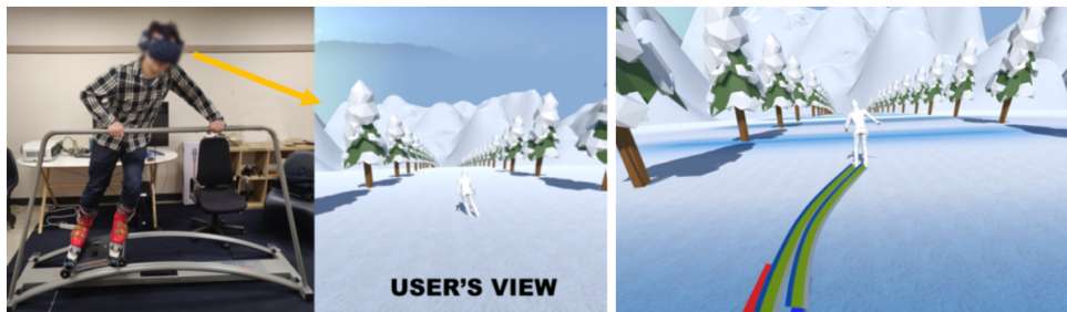
Figure 4.14 – Simulateur de ski en Réalité Virtuelle [Wu+19 ; Wu+20].
