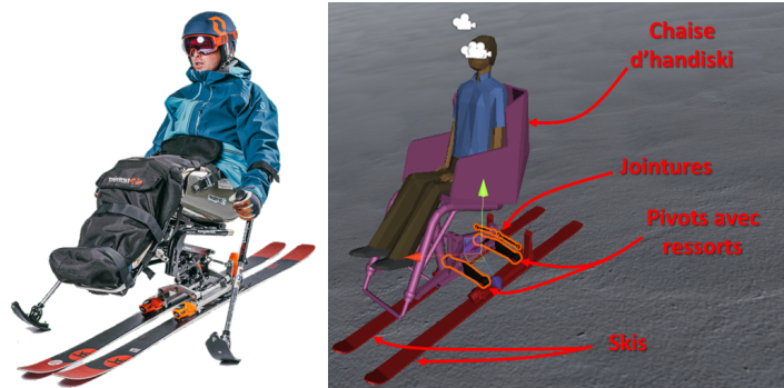
Figure 8.16 – Modélisation CAO d'un modèle double-ski d'handiski.
