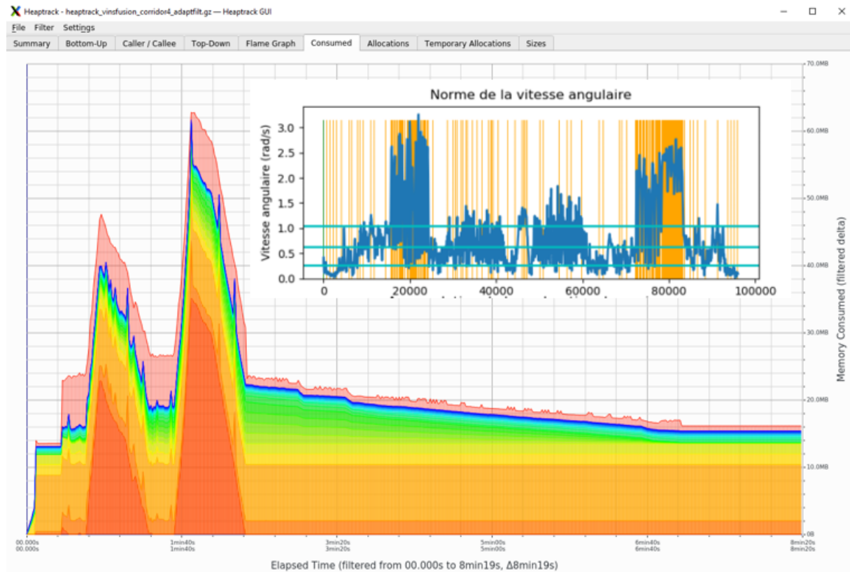
FIGURE 5.19 – Consommation de mémoire de l’algorithme VINSFusion sur corridor4 avec le flux d’entrée adaptatif par l’heuristique AFadapt.
