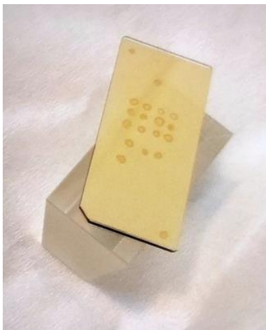
Figure III-2: Photo de la biopuce montée sur le prisme en verre avec la matrice MALDI déposée après l'expérience SPRi sur les sites où les récepteurs ont été immobilisés.
