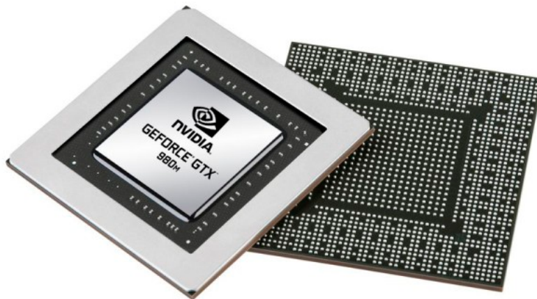
FIGURE 1.1.10 – Exemple de package BGA : processeur graphique NVIDIA GeForce GTX 980M
