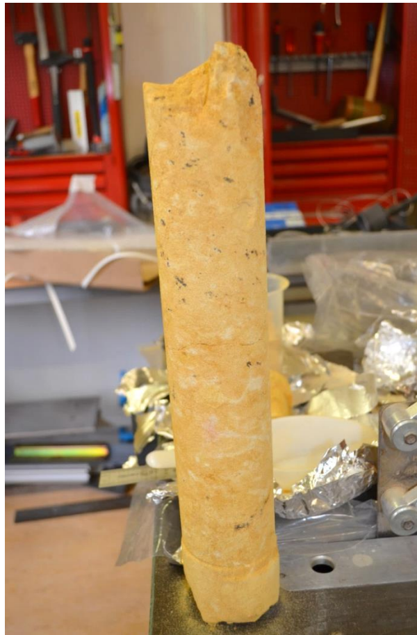
Figure 13 : Carotte de sédiment BO10 après usinage
