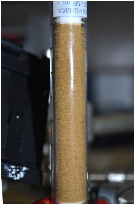
Figure 25. Petite colonne de matériau BO10 saturé
