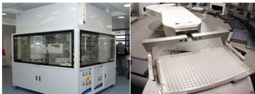
Figure 7 : Aperçu d'une plateforme de criblage haut débit robotisée et d'une plaque 384 puits. Photos prise de la plateforme Biocell à I-STEM.
