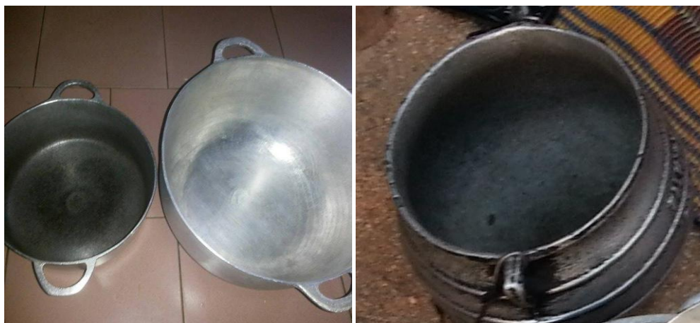
Figure 35 : altération des marmites en fonte d'aluminium fabriquées de façon artisanale
