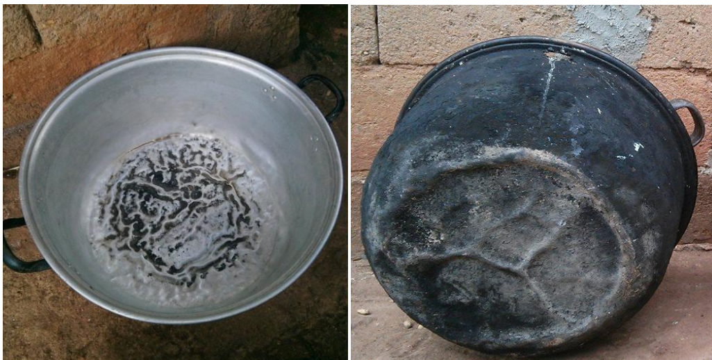
Figure 30 : altération des marmites en aluminium fabriquées par ALUBASSA
