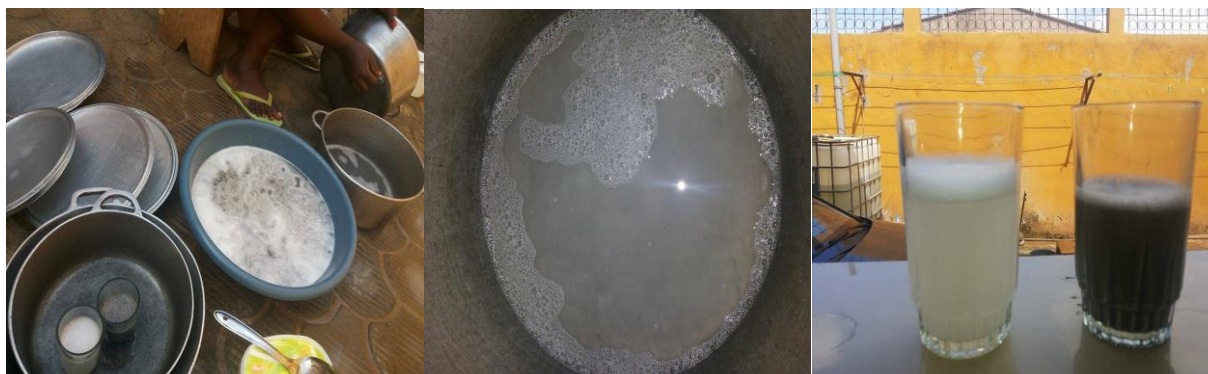
Figure 32: effets du lavage de marmites en fontes d'aluminium fabriquées artisanalement
