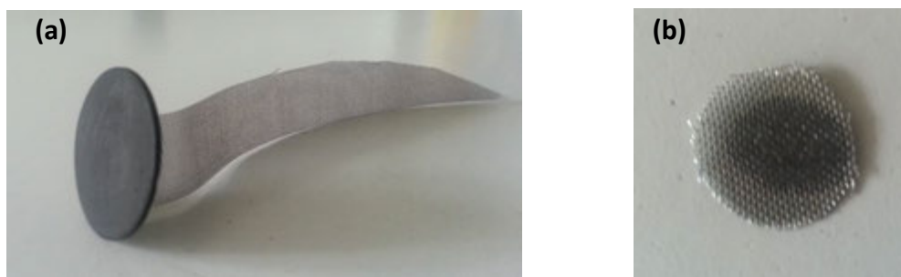
Figure E-1 (a) Exemple d'électrode nanohybride encre de carbone sur disque inox (20 mm diam.), (b) Exemple d'électrode nanohybride graphite compacté sur grille inox (12 mm diam.).
