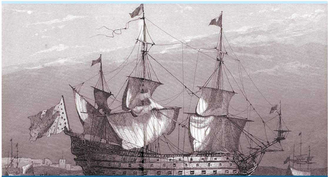
Figure II-2.1/08 – Vaisseau français le *Soleil royal*, 1669 (vaisseau de 1<sup>er</sup> rang, longueur de coque 53,42 mètres, 2 000 tonneaux, 98 puis 104 canons)
