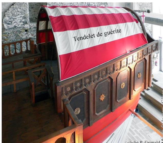
Figure III-3.2/18 – Poupe et tendelet de guérite
