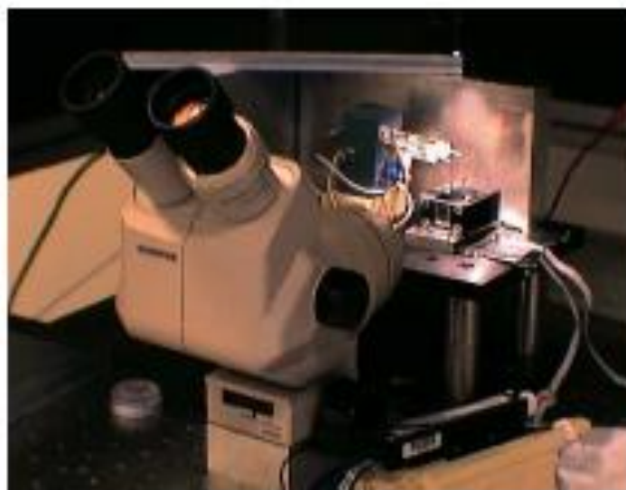
FIG. V.4 - Dispositif de mesure sur les bicouches : cellule de mesure, électrodes, tête de mesure, cage de Faraday (ouverte) et loupe binoculaire
