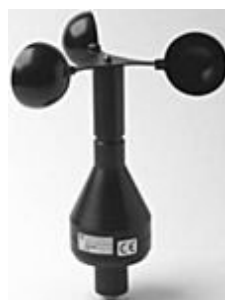
Fig. 3.15 : Anémomètre à trois coupelles (Anémomètre de Robinson)
