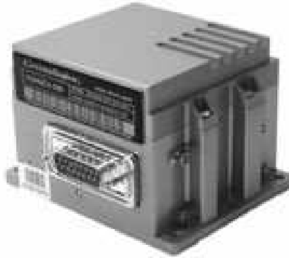
FIG. 7.2 – La centrale inertielle IMU
