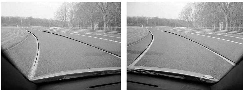
FIG. 7.31 – Résultats de détection des bords gauche et droit de la route - image 7.1- par stéréovision)
