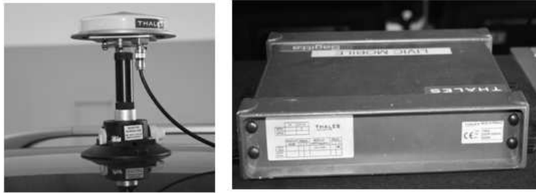
FIG. 7.4 – Le système GPS-RTK
