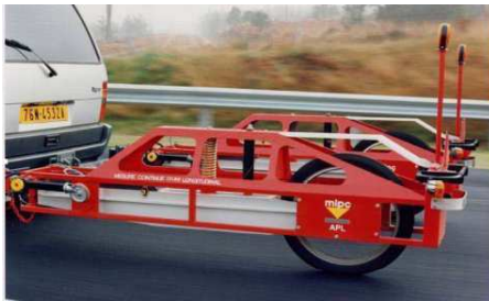
FIG. 1.6 – L'Analyseur de Profil en Long (APL) et son schéma de principe
