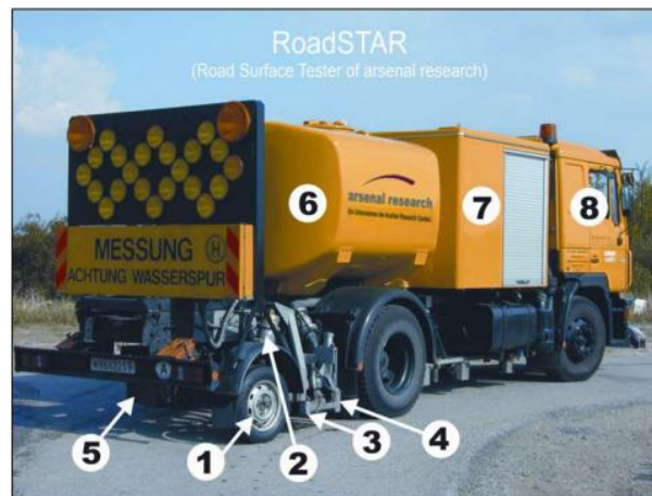
FIGURE 2.36 – Appareil de mesure RoadSTAR : 1, roue de mesure ; 2, cylindre pneumatique ; 3, unité de mouillage ; 4, système de prémouillage ; 5, réducteur de vitesse ; 6, réservoir d'eau ; 7, unité de rangement ; 8, cabine conducteur
