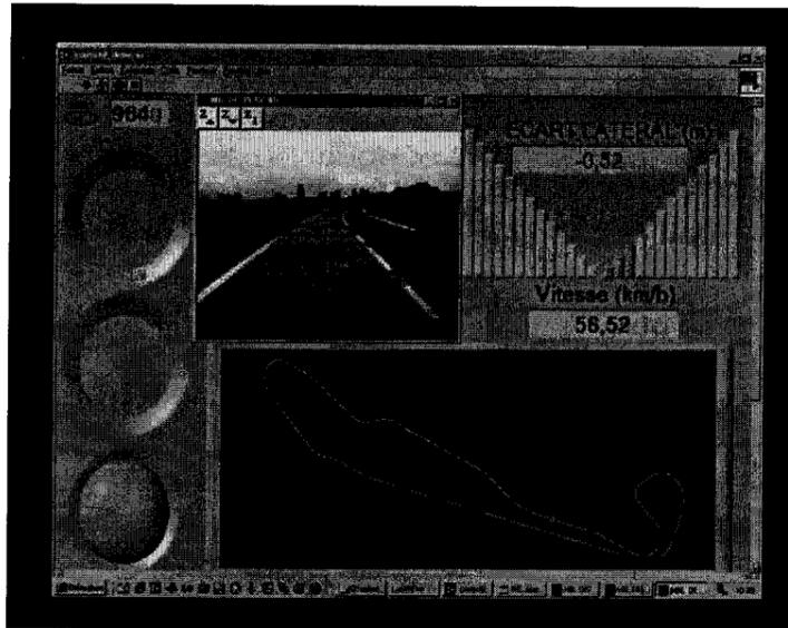
FIG. 1.2 – Interface d'assistance au maintien de voie par vision frontale
