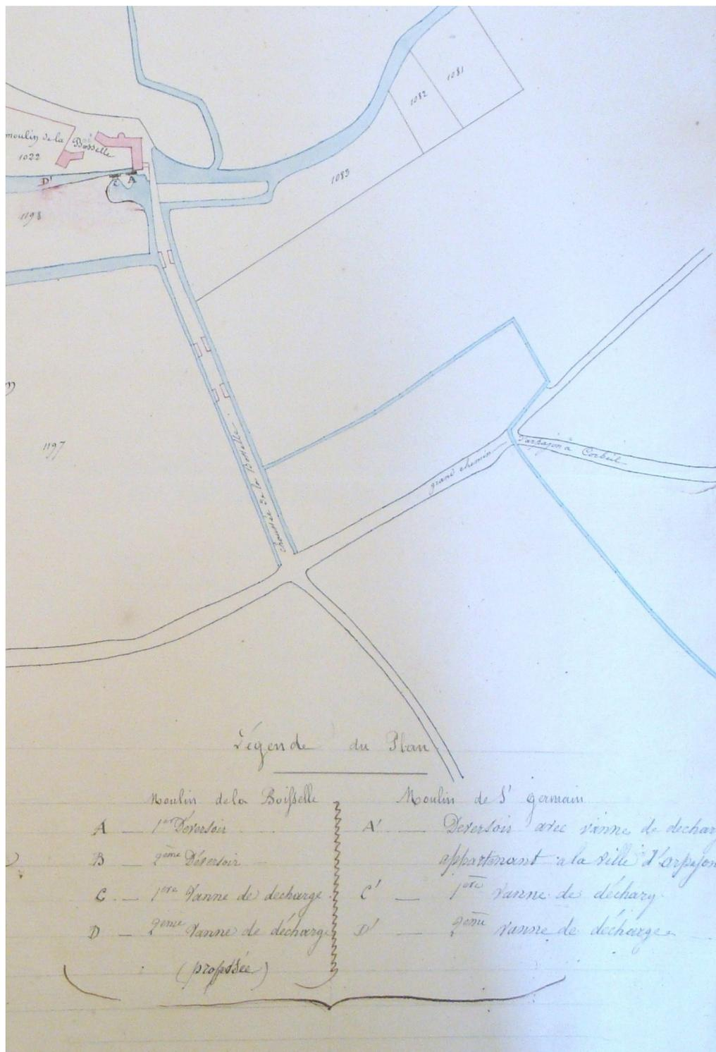
La seconde partie représente elle le moulin de la Boisselle avec l'un de ses déversoirs (A) et l'une de ses vannes de décharge (C).
