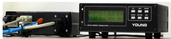
Figure 3.6 : Système d'acquisition de la station météo. A droite l'interface de communication, à gauche la centrale d'acquisition
