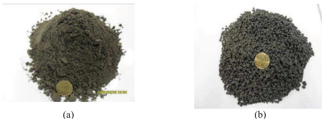
**Figure III-B-1 :** Cas de mauvaises formulations (a) mélange trop sec (b) formation de grumeaux
