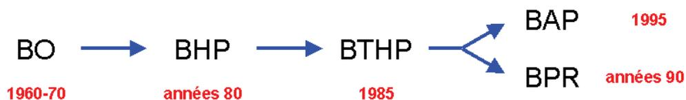
**Figure I-B-3** : Evolution des bétons depuis les années 1960. On observe d'abord un progrès constant des performances dans une même direction, puis une spécialisation entre deux types de bétons ayant des objectifs distincts
