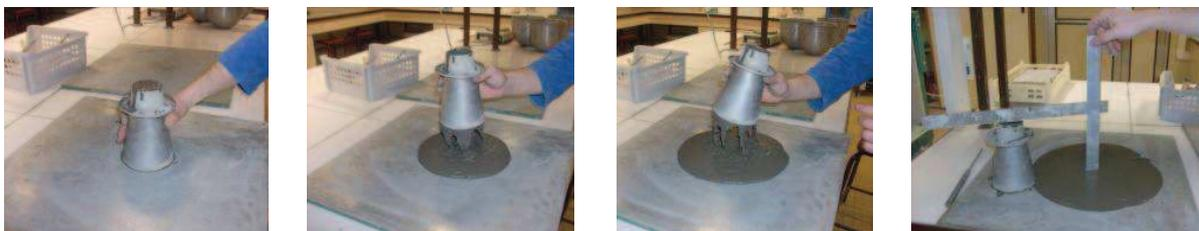
**Figure III-B-3 :** *Essai d'étalement au cône d'Abrams*
