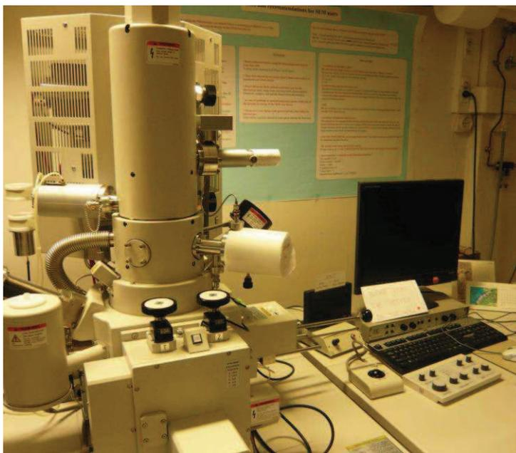
**Figure II-B-2 :** *Microscope électronique à balayage (MEB-FEG)*
