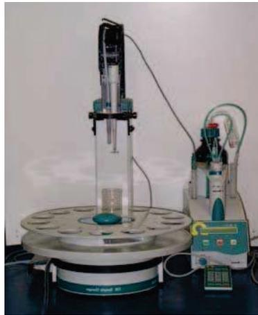
**Figure II-F-7 :** Essai de durabilité aux ions chlore. Photo du titrimètre
