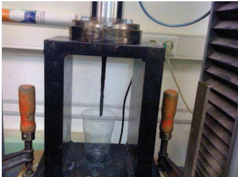
**Figure IV-A-6 :** *Extrudat d'une formulation non extrudable (BPR3) : boudin inhomogène*
