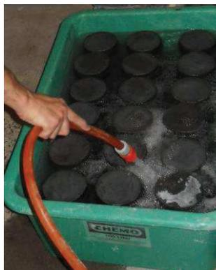
**Figure III-B-6 : Conservation humide des éprouvettes**
