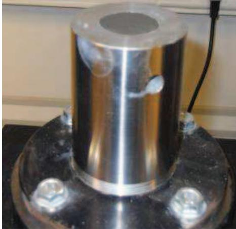
**Figure IV-A-4** : Réservoir rempli du matériau tassé
