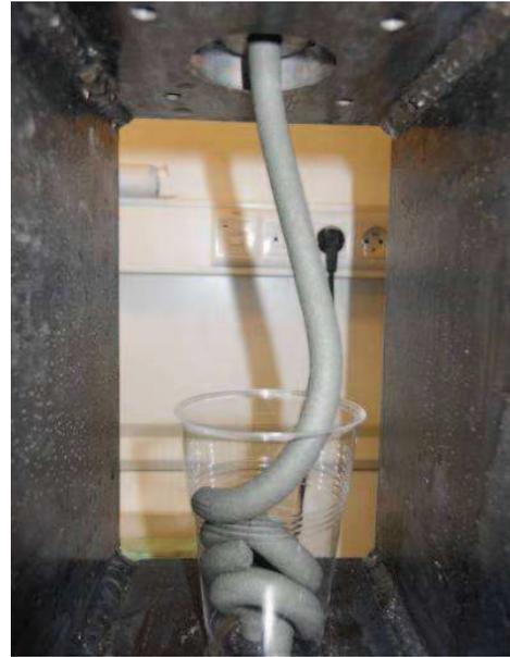
**Figure IV-A-5 :** *Essai d'extrusion sur BPR extrudable : boudin homogène et sans fissure*
