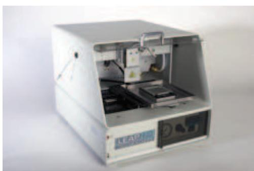
Figure 21 : Photographie du nébuliseur Leap Technologies utilisé au laboratoire.
