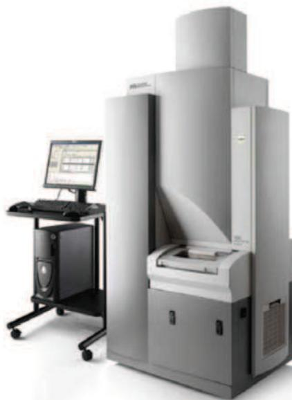
Figure 17 : Photographie du spectromètre de masse MALDI TOF-TOF 4800 Applied Biosystems / MDS Sciex.
