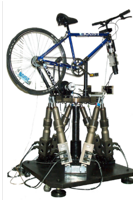
FIGURE 1.23 – Simulateur du véhicule deux-roues non motorisé - Korée
