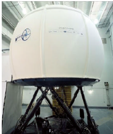
FIGURE 1.8 – Simulateur à plateforme Gough-Stewart du VIRTTEX - USA
