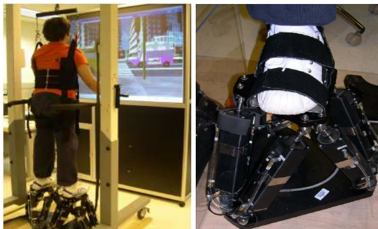
FIGURE 1.14 – (a) Simulateur de mobilité, (b) Plateforme parallèle Rutgers Mega-Ankle
