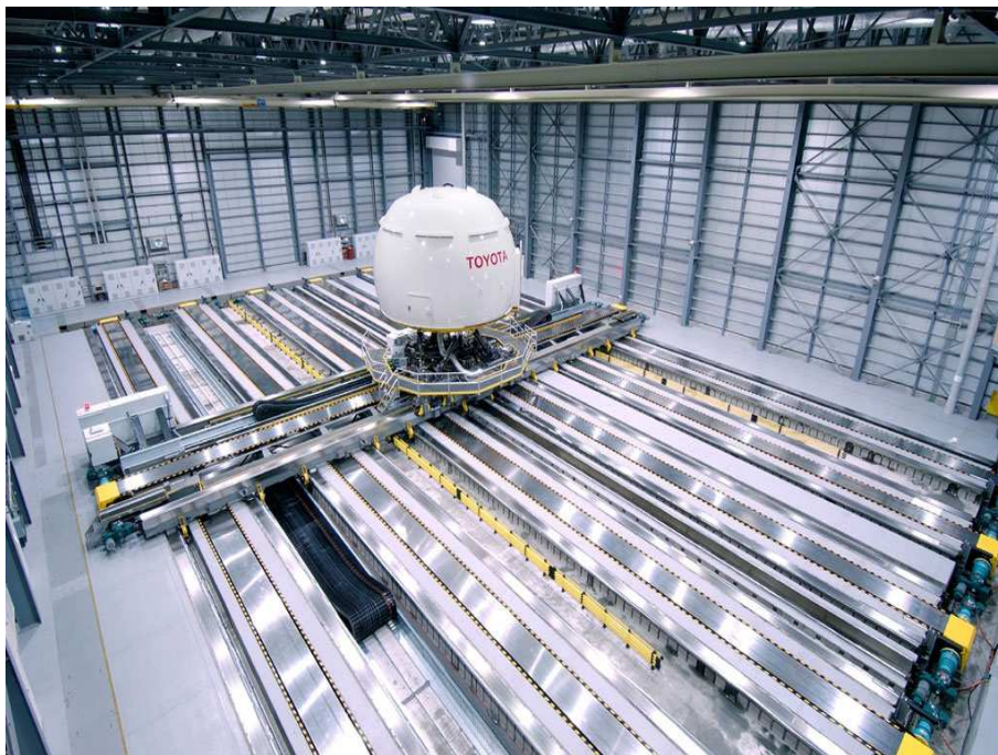
FIGURE 1.12 – Simulateur de Toyota - Centre Technique de Toyota à Susono City, Japon
