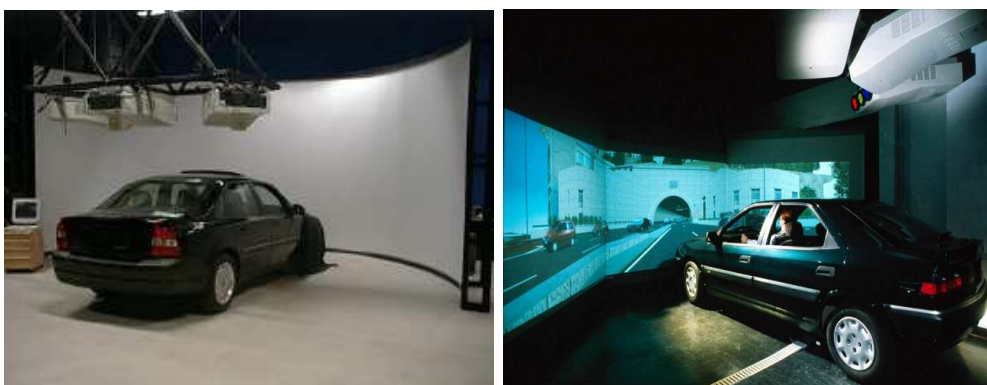
FIGURE 1.3 – Simulateurs à base fixe : (a) Simulateur Volvo - Suède Johansson et Nordin (2002) (b) Simulateur à base fixe de l'INRETS Arcueil - France Espié (2000)
