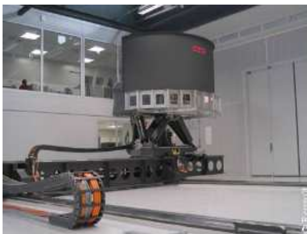
FIGURE 1.9 – Architecture hybride du simulateur ULTIMATE de Renault - France
