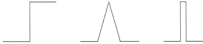
Figure 3-4. Différents types de contours.
