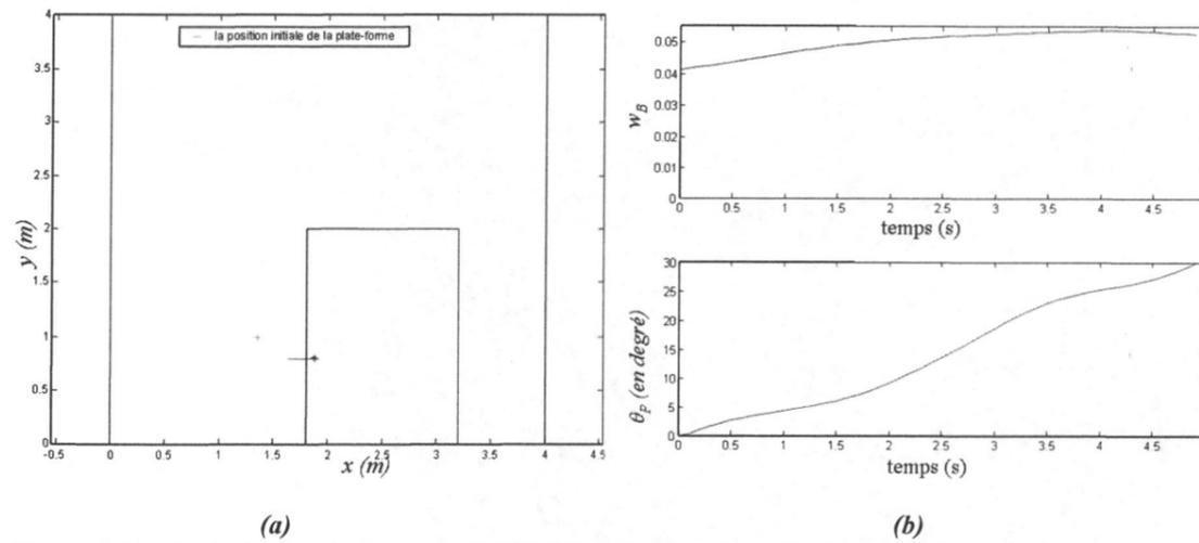
Figure 4-22 : Optimisation de la manipulabilité globale directionnelle du manipulateur mobile  $\tilde{w}_{dir}$  : a) trajectoire de l'OT, b) évolutions de la mesure de manipulabilité  $w_B$  et de l'orientation de la plate-forme.
