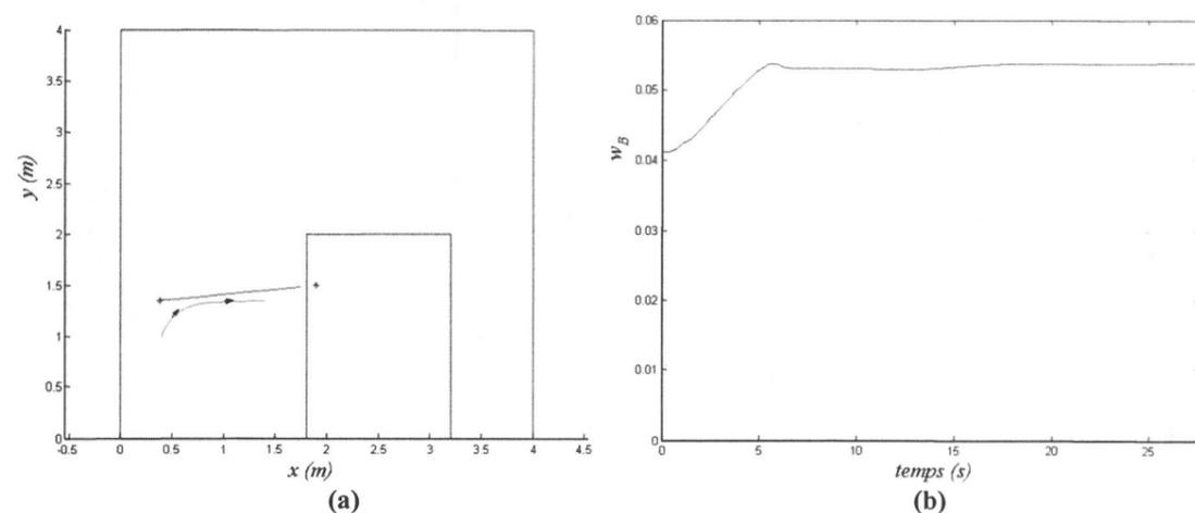
Figure 4-13 : Optimisation de la manipulabilité globale directionnelle du manipulateur mobile  $\tilde{w}_{dir}$  et évitement d'obstacle: a) trajectoires de la plate-forme et de l'OT, b) mesure de manipulabilité  $w_B$ .
