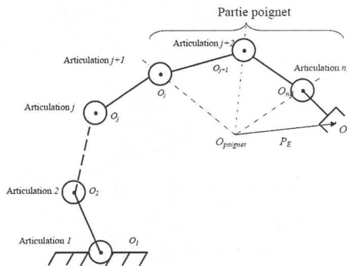
Figure 3-1 : Structure générale d'un bras manipulateur.
