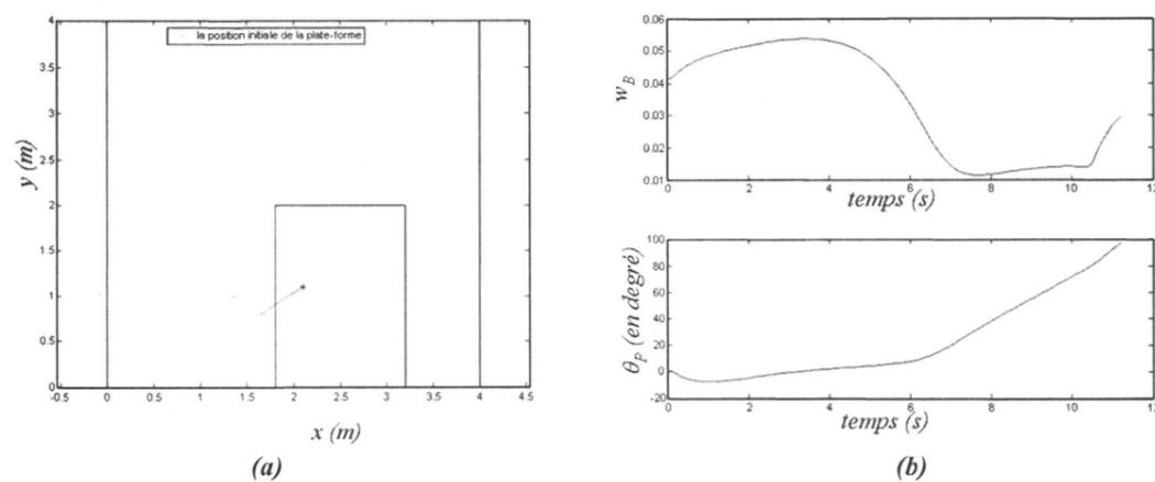
Figure C-8 : Optimisation de la manipulabilité directionnelle du bras  $w_{Bdir}$  : a) trajectoire de l'OT, b) évolutions de la mesure de manipulabilité  $w_B$  et de l'orientation de la plate-forme.
