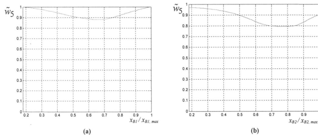
Figure 3-6 : Mesures normalisées de la manipulabilité du manipulateur mobile  $\tilde{w}_5$ . : a) mouvements de l'OT perpendiculaire à l'axe de déplacement longitudinal de la plate-forme, b) mouvements de l'OT parallèle à l'axe de déplacement longitudinal de la plate-forme.
