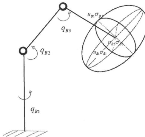
Figure 1-10 : Ellipsoïde de manipulabilité en 3D.
