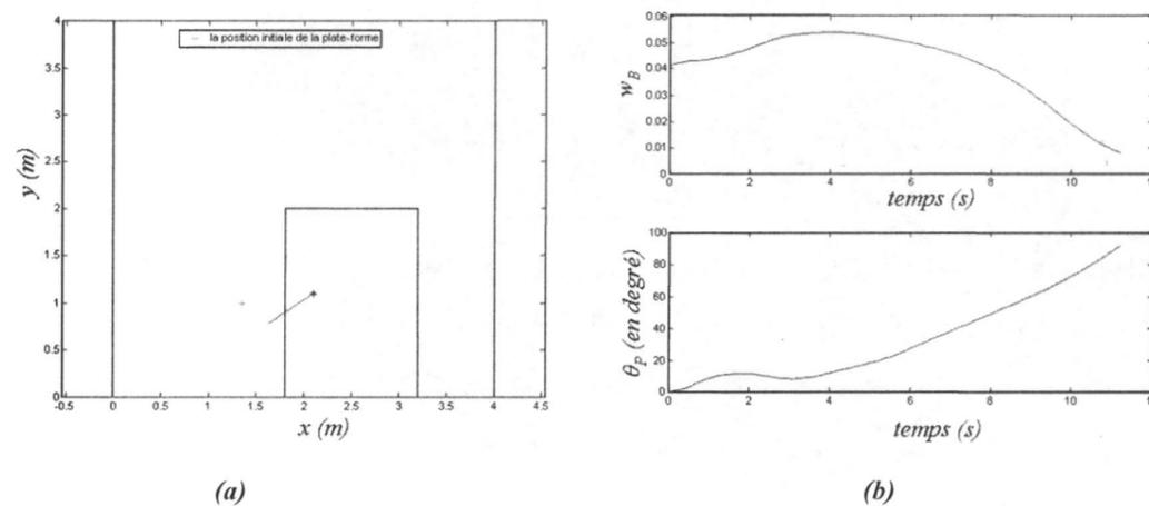
Figure C-10: optimisation de la manipulabilité directionnelle globale du manipulateur mobile  $\tilde{w}_{dir}$  : a) trajectoire de l'OT, b) évolutions de la mesure de manipulabilité  $w_B$  et de l'orientation de la plate-forme.
