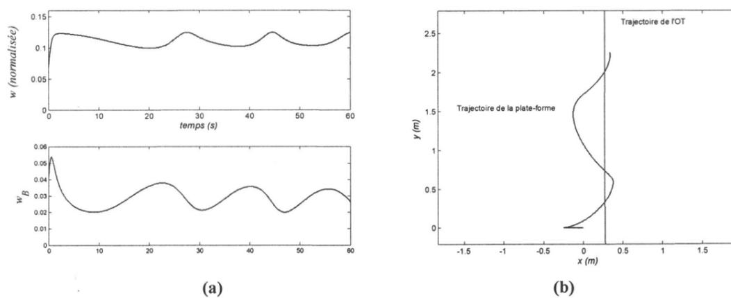
Figure 3-12: Résultats obtenus en optimisant la manipulabilité normalisée du manipulateur mobile  $\tilde{w}$  : a) évolution de la mesure de manipulabilité, b) trajectoires de la plate-forme et de l'OT.
