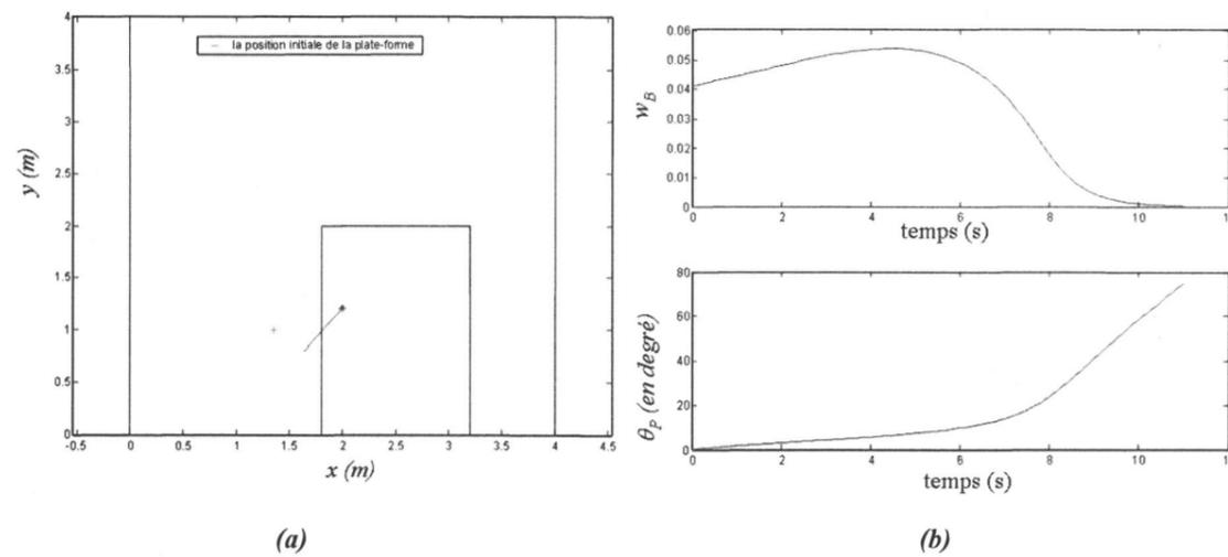
Figure 4-17 : optimisation de la manipulabilité globale du manipulateur mobile  $\tilde{w}$  : a) trajectoire de l'OT, b) évolutions de la mesure de manipulabilité  $w_B$  et de l'orientation de la plate-forme.
