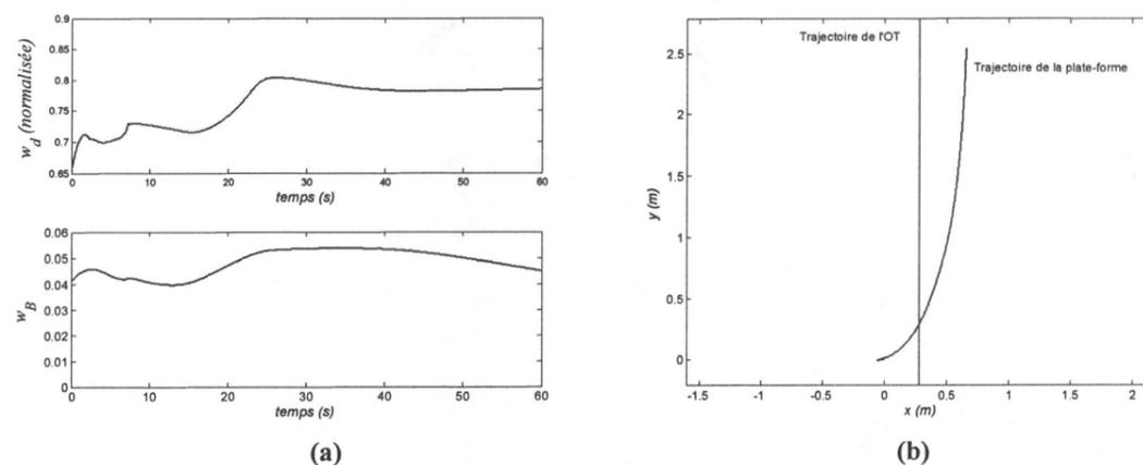
Figure 3-13 : Résultats obtenus en optimisant la manipulabilité directionnelle globale du manipulateur mobile : a) évolutions des mesures de manipulabilité  $\tilde{w}_{dir}$  et  $w_B$ , b) trajectoires de la plate-forme et de l'OT.
