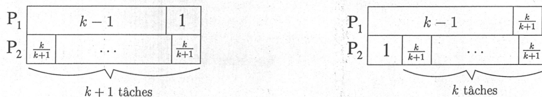
FIG. 5.3 – Gauche : Ordonnancement optimal pour la date de fin, et équilibre de Nash k -approché (les politiques des machines sont LPT). Droite : Ordonnancement approché pour la date de fin.
